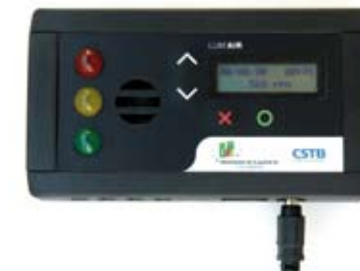
Lum'Air, appareil de mesure du confinement
